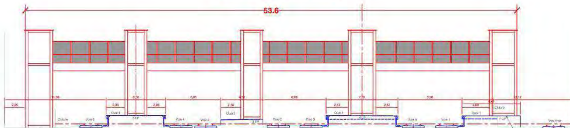
COUPE LONGITUDINALE DE L'ENSEMBLE DE LA PASSERELLE
